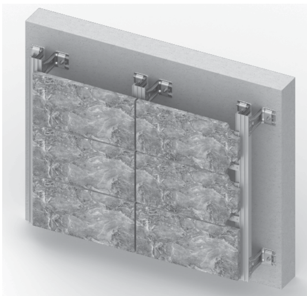
9) Kamena fasada sa nevidljivim zalivenim kopčama
